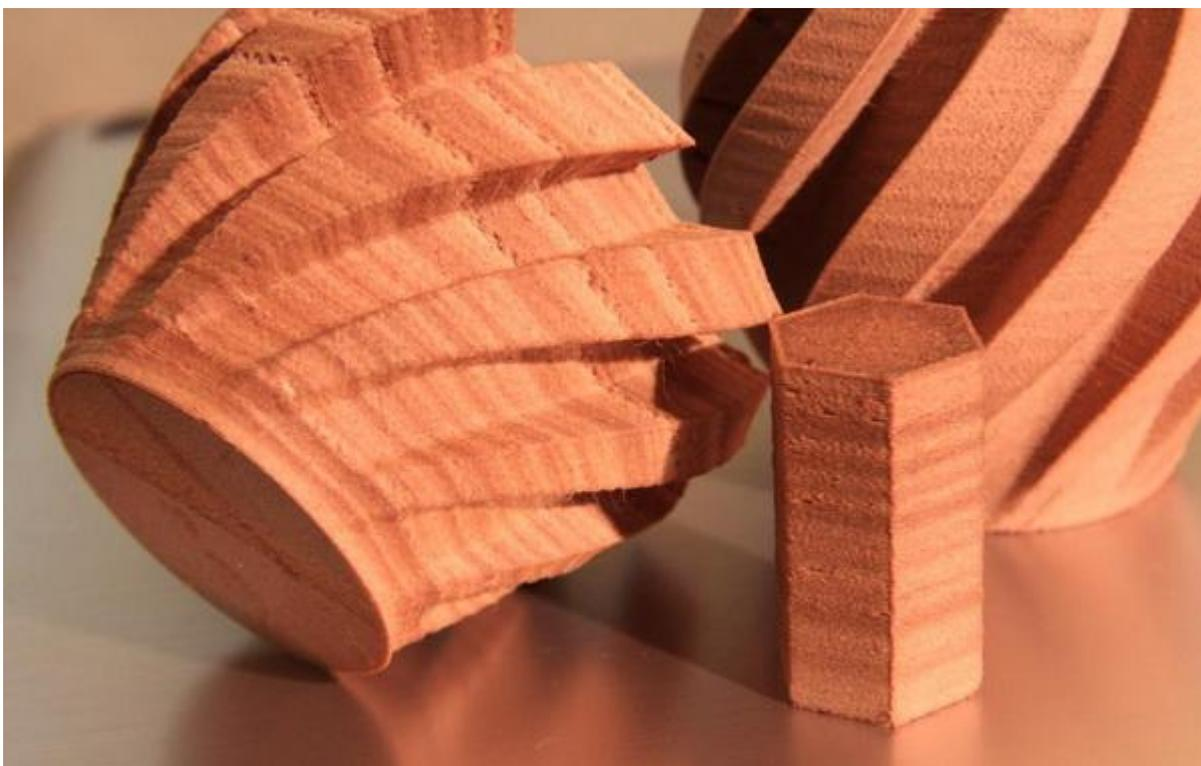
LAYWOO-D3 – недавняя разработка, предназначенная для печати моделей, напоминающих деревянные изделия. Материал на 40% состоит из натуральных древесных опилок микроскопического размера и на 60% из связующего полимера. LAYWOO-D3 весьма прост в обращении, будучи практически неподверженным деформациям и не требуя использования подогреваемой платформы. Согласно производителям, полимер нетоксичен и полностью безопасен.
